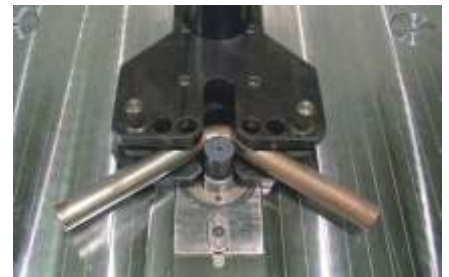
Doblado de barra Cintrage de barres Bending of bar
